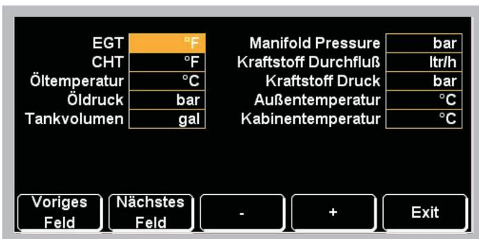
Über einfach verständliche Menüs können die alle wichtigen Parameter für jeden Piloten und jedes Flugzeug angepaßt werden. Zum Beispiel können die Einheiten individuell für jeden Wert konfiguriert werden (siehe Bild oben). Werksseitig werden die Farbmarkierungen für die verschiedenen Flugzeugtypen eingestellt.
