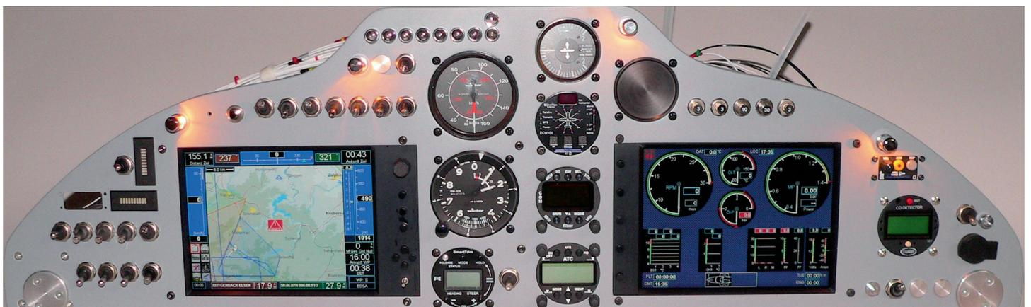
**Modernes UL-Panel ausgerüstet mit dem Glascockpit VP-EFIS und VP-EMS**
